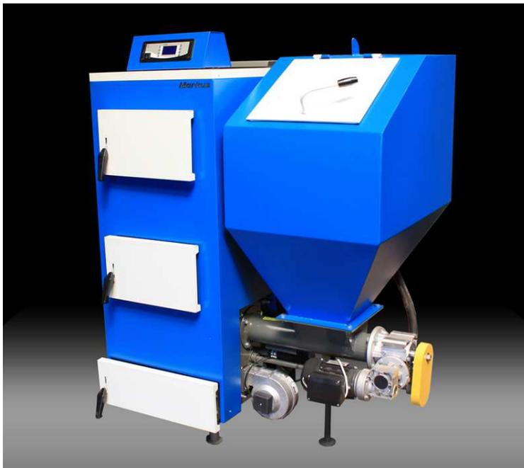
Dieser Zentralheizkessel erhitzt das Wasser, welches über eine Umwälzpumpe zu den Heizkörpern transportiert wird. Diese Heizkörper erwärmen dann die Räume. Da sowohl die Umwälzpumpe, die elektronische Steuerung, als die Förderschnecke und das Gebläse benötigen Strom. Daher kann man diese Heizung nicht ohne Strom betreiben! Auch ist diese Heizung nur mit Steinkohle betreibbar.
