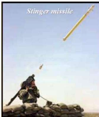
Diese findet jedes Flugzeug oder Helikopter mit genügend Wärmeabgabe aus den Triebwerken innerhalb von 4km Reichweite. Sie arbeitet nach dem „Fire and Forget“ System und steuert selbsttätig auf das Ziel, wo sie explodiert.
